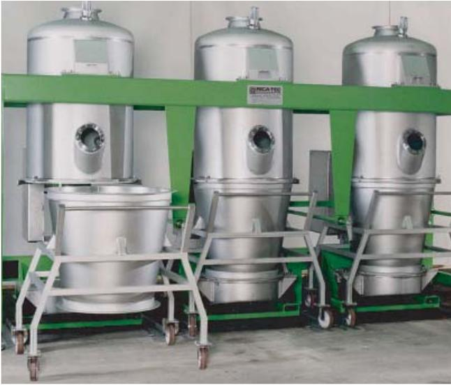
带可拆卸物料容器的批处理流化床
