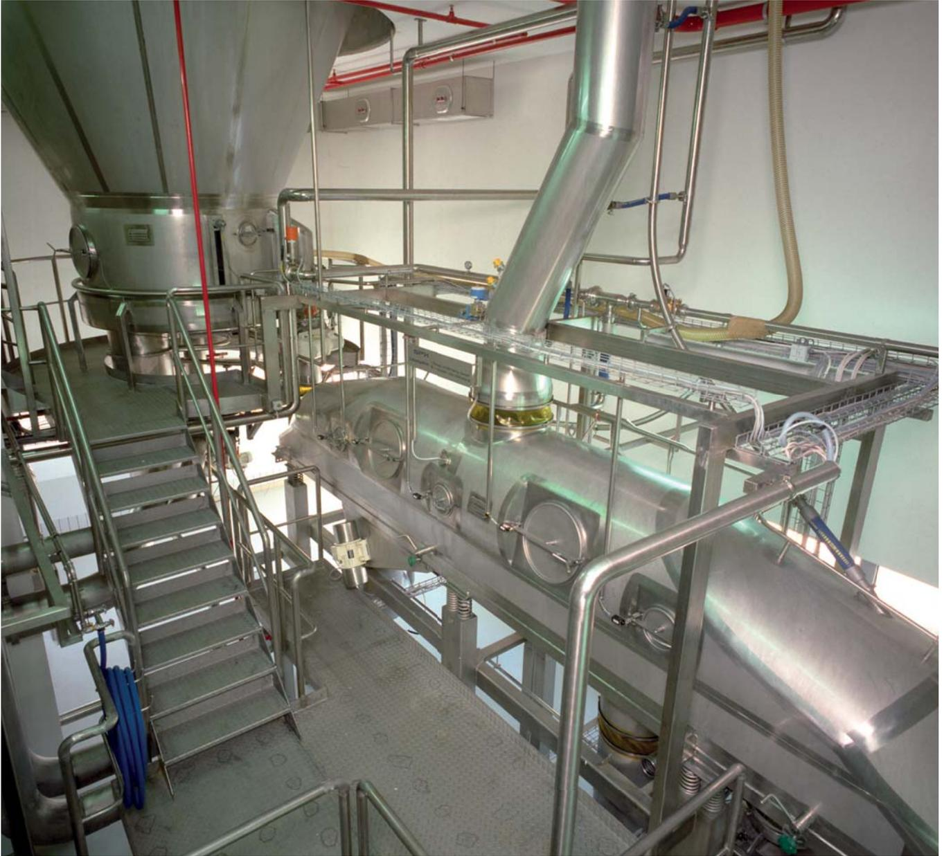
流化床通常作为内置流化床或外置流化床与喷雾干燥装置结合使用。流化床的优势在于其产物质量更佳，干燥效率更高。
