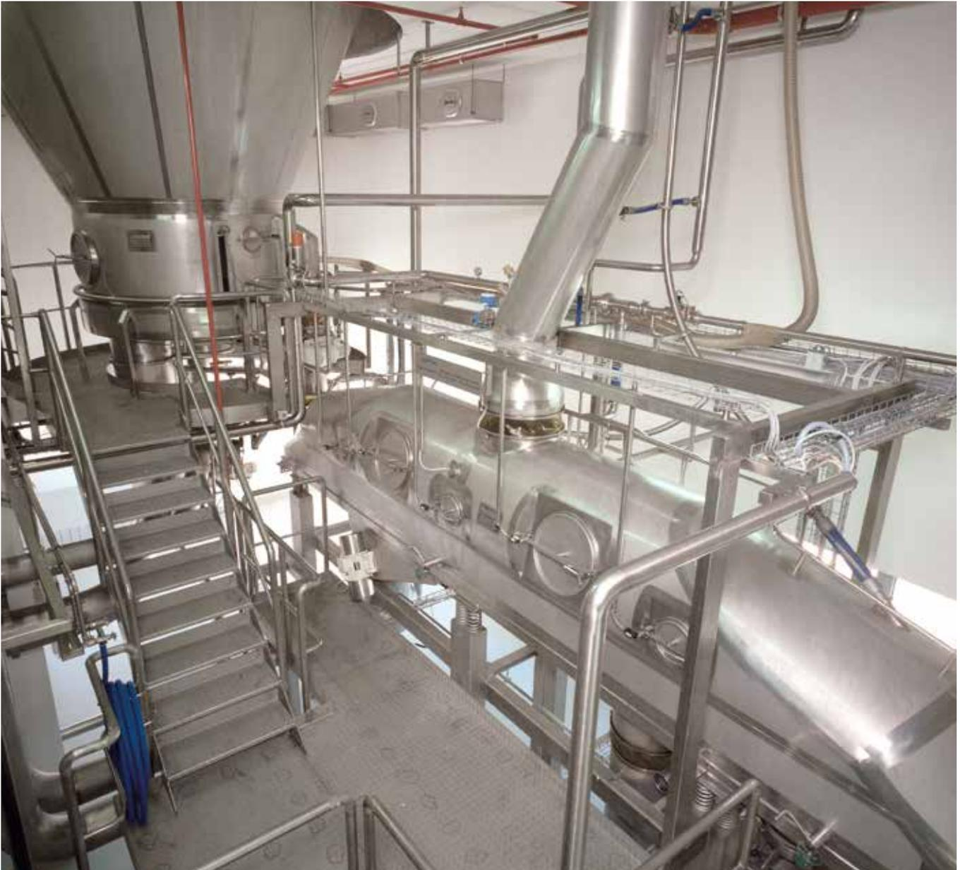
Fließbette werden oft in Verbindung mit Sprühtrocknungsanlagen verwendet, als ein internes Fließbett und/oder ein separates externes Fließbett. Die Vorteile sind eine bessere Produktqualität und ein effizienterer Trocknungsprozess.
