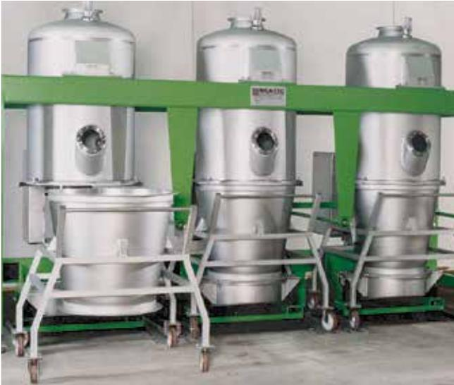
**Chargen-Fließbettanlagen mit transportablen Produktbehältern**
