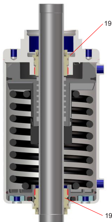
Fig. 12.: Actuador de la válvula D4
